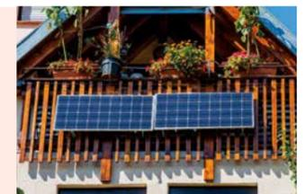
Allgemein bekannt sind sie als „Balkonkraftwerk“, weil sie sich an die Balkonbrüstung befestigen lassen, offizielle Bezeichnungen dafür gibt es mehrere: Mini-Photovoltaikanlagen für den Balkon, Stecker-Solargeräte, Balkon-PV-Anlage, Balkonmodule, Mini-Solaranlagen, Mikro-Solarsysteme, Plug & Play-Geräte (bis zu 350 Watt).
