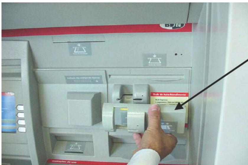
Finta fessura per l'inserimento della carta che viene posta sopra quella effettiva. Contiene un ulteriore lettore di banda magnetica per la copiatura dei dati.
